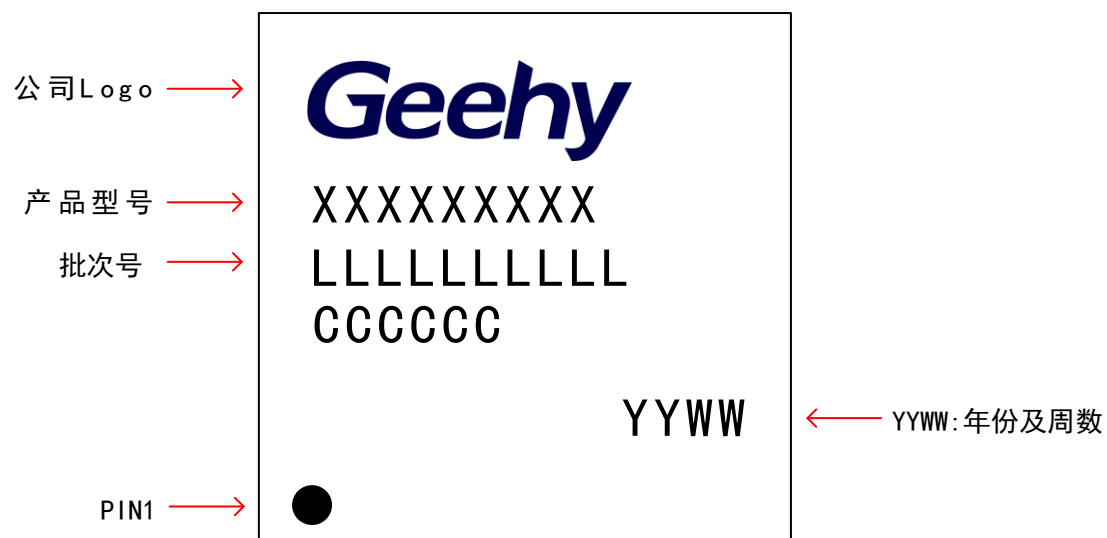
图 5 E-TQFP48-48 引脚，7mm x 7mm 示意图
